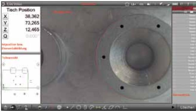
**La mesure s'effectue toujours en mode « live »**, c'est-à-dire dans l'image en direct de la pièce à mesurer. La détection optimale des arêtes présentes dans la pièce est assurée au moyen de l'outil « MeasureLogic » ou en employant la fonction « Réticule actif » ou « Réticule fixe ». Pour créer la fenêtre de mesure, il suffit de sélectionner l'élément souhaité en touchant l'écran multitactile et faire glisser l'arête. Bien sûr, ce procédé peut être également effectué avec la souris.
