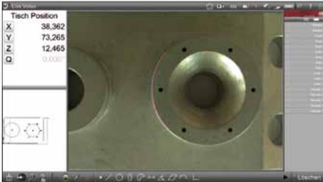
Les **résultats de mesure obtenus** sont enregistrés dans un graphique qui peut également être **affiché dans l'image en direct**. Ce procédé établit une relation directe entre la pièce à mesurer réelle et le dessin de base correspondant.
