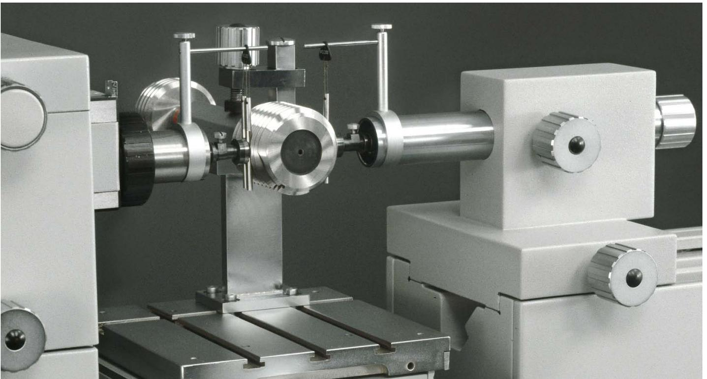
**Mesure d'une cale étalon:** la mesure est effectuée après calibration sur une cale de référence
