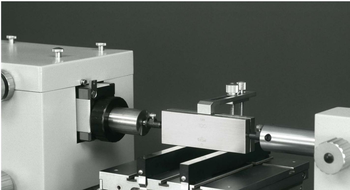
**Mesure d'un micromètre intérieur**
