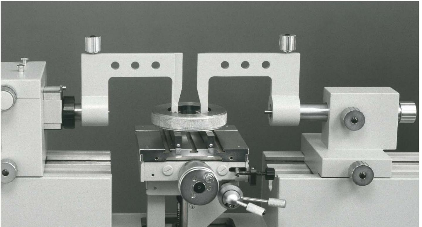
**Mesure d'une bague fileté:** une paire de larges bras de contact et une paire de petits bras de contact, équipées de 12 paires de sphères calibrées permettant ce type de contrôle
