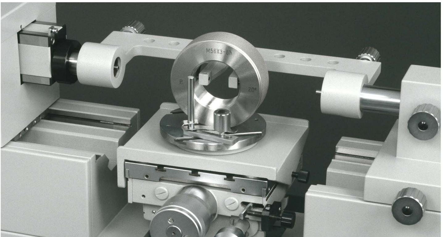
**Mesure de petit diamètre intérieur:** la mesure s'effectue avec une force de contact égale à zéro
